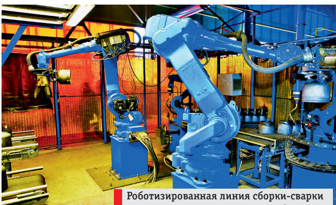
Роботизированная линия сборки-сварки 12- и 27-литровых газовых евробаллонов
