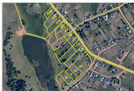
Выполнение топогеодезической съемки масштаба 1:500 беспилотными летательными аппаратами
