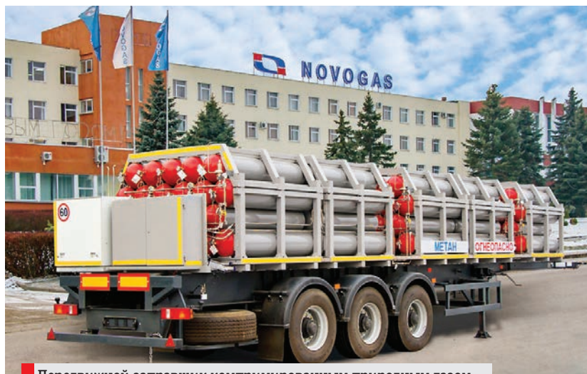
Передвижной заправщик компримированным природным газом
