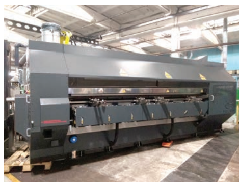
Станок с числовым программным управлением горячей объемной безоблойной штамповки
