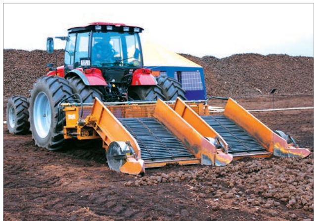
Валкователь кускового торфа КТВ-1
