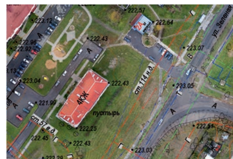
Фрагмент топографической съемки масштаба 1:2000 г. Фаниполь совмещенной с ортофотопланом
