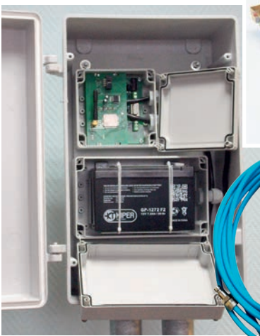
Опытный образец комплекса мониторинга защитного потенциала металлических трубопроводов
