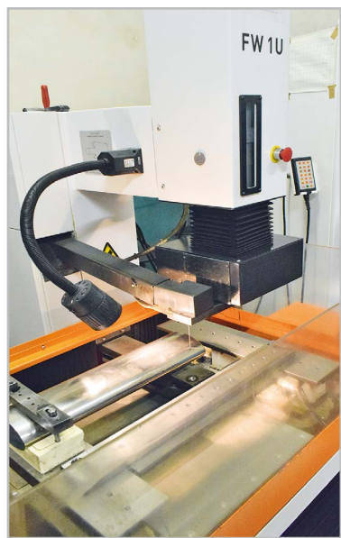
Проволочный электроэрозионный станок, на котором было изготовлено 200 факелов для эстафеты «Пламя мира» II Европейских игр
