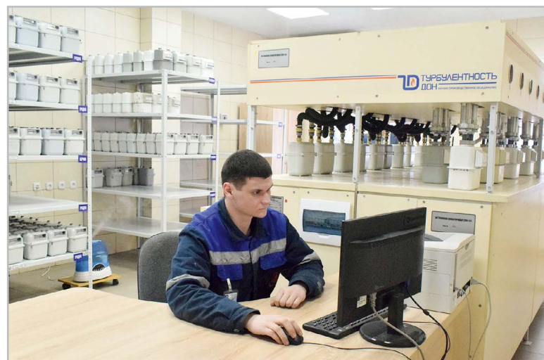
Слесарь КИПиА службы метрологии УП «Гроднооблгаз» В.Д. Белявский ведет поверку индивидуальных приборов учета расхода газа на установке СПУ-5Э
