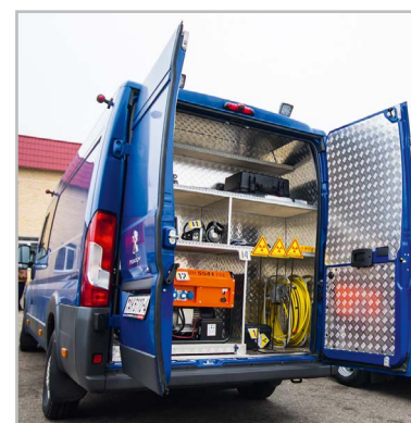
Грузовой отсек передвижной лаборатории неразрушающего контроля сварных соединений
