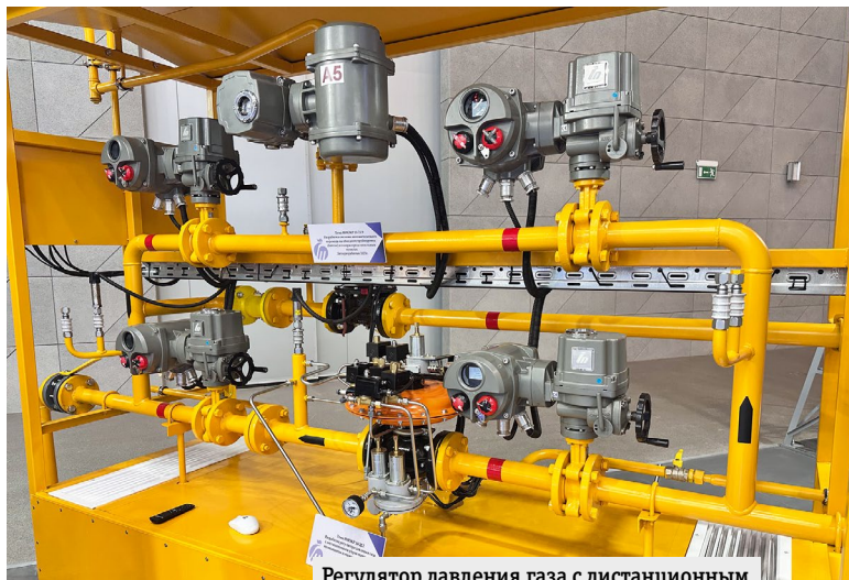
Регулятор давления газа с дистанционным управлением (РДГДУ)
