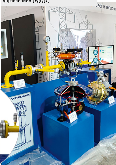
Регулятор давления газа с дистанционным управлением (РДГДУ)
